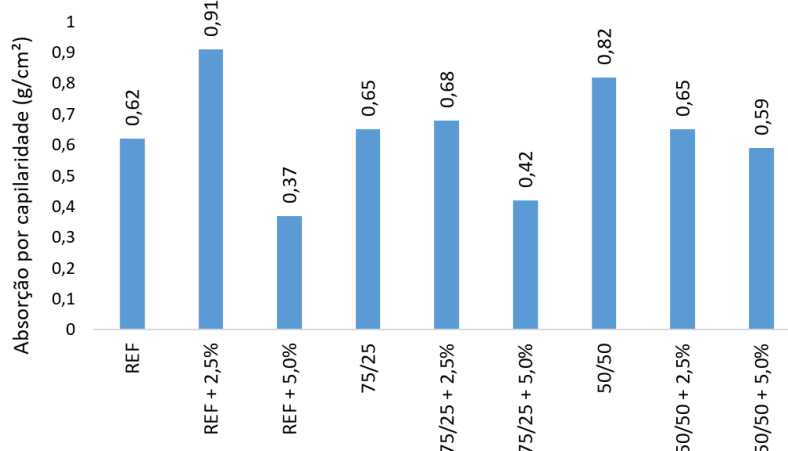
Figura 1: Média da absorção de água por capilaridade ao final de 72 horas de ensaio
