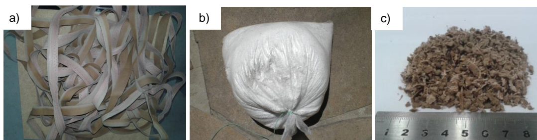
Figura 1: (a) resíduo têxtil recoberto com poliuretano (PU) recolhido na fábrica de calçados; (b) resíduo de EVA em pó gerados também na indústria calçadista do Vale do Rio dos Sinos (RS); (c) agregado leve (AL) pronto para o preparo das matrizes à base de Cimento Portland
