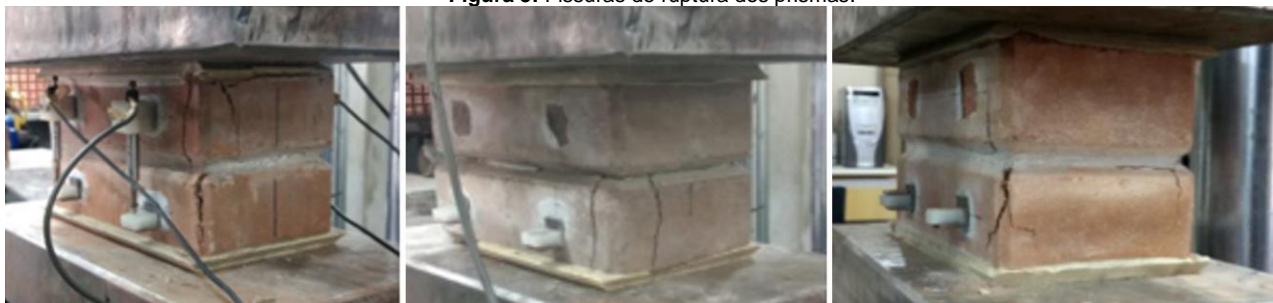
Figura 5: Fissuras de ruptura dos prismas.
