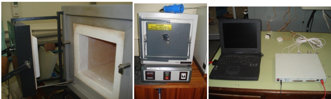
Figura 2: Forno Mufla e Sistema de aquisição de dados (SAD)
