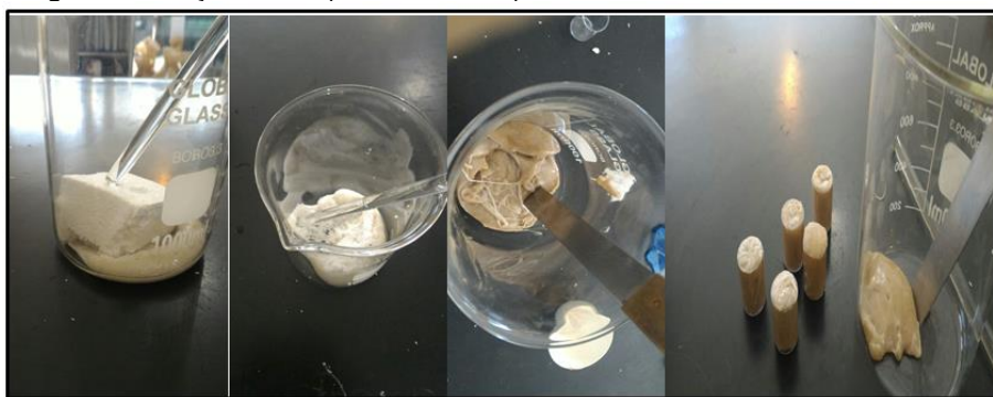
Figura 1: Produção dos compósitos de matriz polimérica a base de EPS e RCD de classe A
