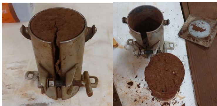
Figura 2. Corpos de prova com desagregação e aderência de material na forma.
