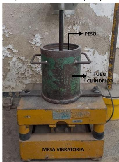
O valor experimental essencial para a utilização do *software* consiste na determinação da densidade de empacotamento real de cada classe de agregado, por fração granulométrica. Desta forma, para realizar o ensaio, primeiramente, a areia e o ABR foram divididos em faixas granulométricas, conforme apresentado na Tabela 1. Optou-se por utilizar apenas uma faixa granulométrica do ABR, visto que essa faixa representa aproximadamente 70% do material.
