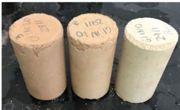
Figura 1 – Corpo de prova de argamassa - ensaio da NBR 9778/2005
