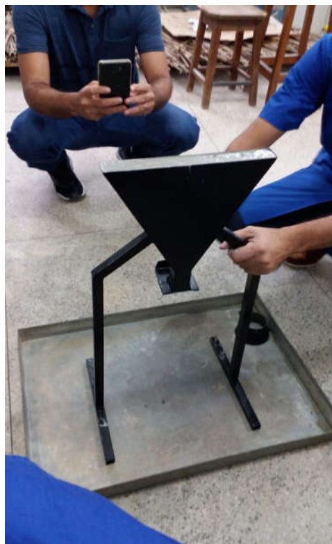
Figura 5 – Determinação do tempo de fluxo da mistura.
