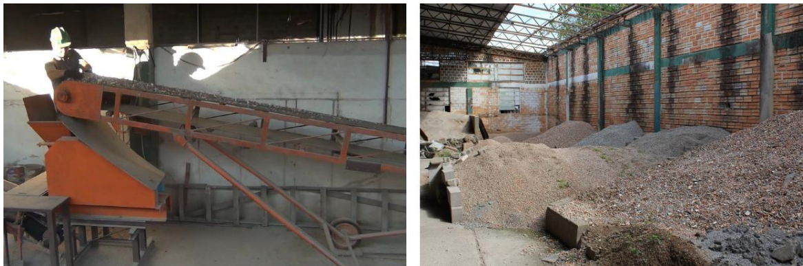
Figura 2 – Esteira com britador e armazenamento dos agregados
