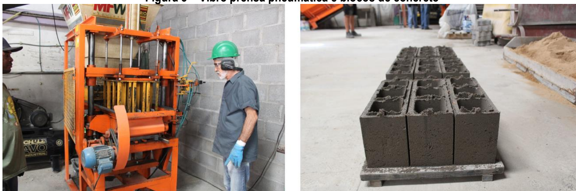
Figura 3 – Vibro prensa pneumática e blocos de concreto
