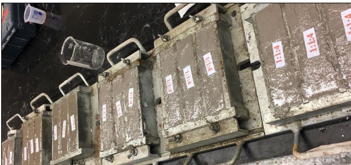
Para cada traço, foram determinados o índice de consistência<sup>(12)</sup>, além da resistência à tração na flexão e resistência à compressão<sup>(13)</sup>, como mostra a Fig. 3. Os corpos de prova foram rompidos após um período de 28 dias de cura em câmara climatizada (temperatura de 25 °C e umidade de 60%).
