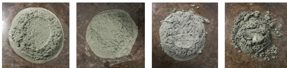
Figura 11 – Resultado final do ensaio de consistência para a argamassa (a) referência e reforçada com (b) 0,3%, (c) 0,6% e (d) 1,0% de fibra de coco.
