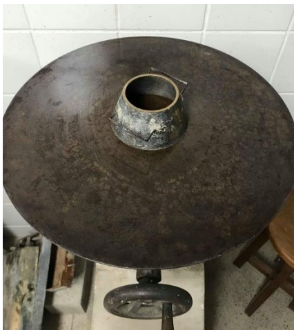
Figura 8 – Mesa e molde metálico utilizado para obtenção do índice de consistência das argamassas.
