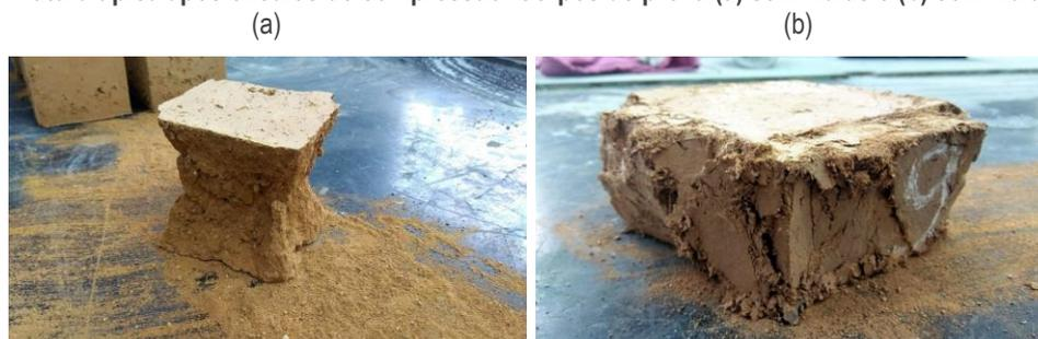
Em relação aos ensaios de flexão, os valores apresentados na Tabela 3 indicam que houve um aumento de 21% na tensão de primeira fissura quando 0,50% de fibras R-PET foi adicionada à mistura
