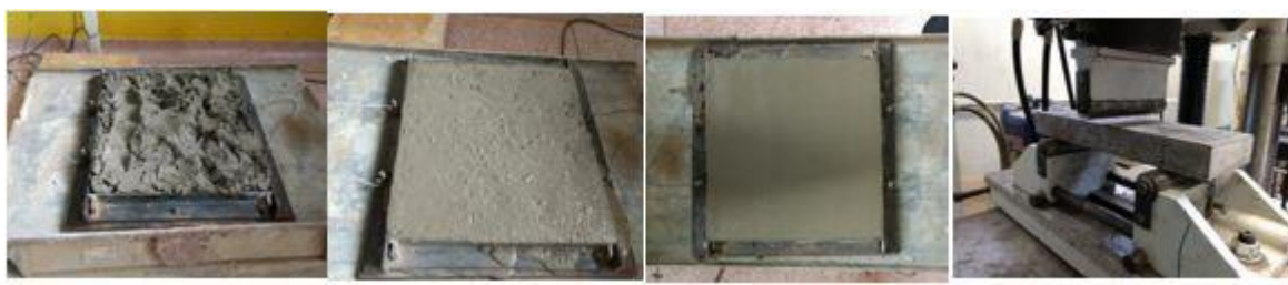
Figura 1 – Processo de fabricação da placa por vibração e ensaio mecânico
