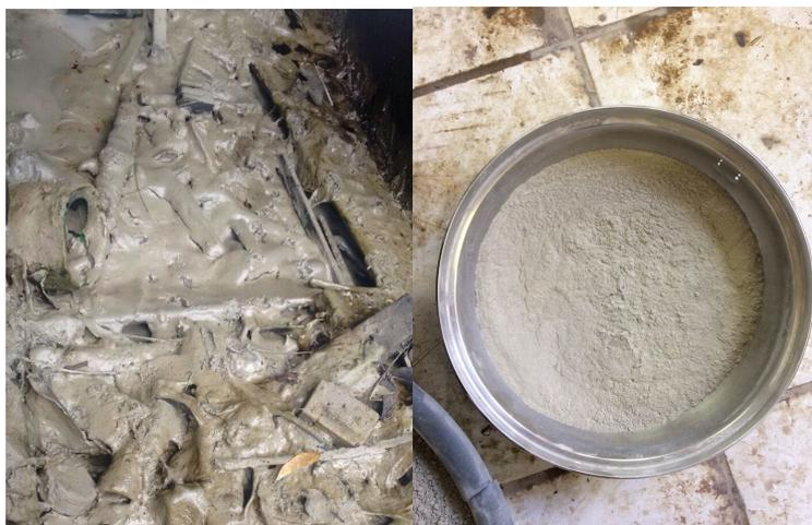
Para a caracterização física do resíduo, sua massa específica é de  $2,75 \text{ g/cm}^3$  e sua finura, pela peneira #200 de 17% <sup>(16)</sup>. Assim como o do cimento, foi feita a granulometria a laser de ambos os
