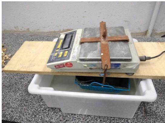
Antes do teste é preciso secar a amostra por 24 horas em estufa à temperatura entre 105 e 110°C e deixá-la resfriar ao ar à temperatura ambiente, para então pesar uma quantidade de material seca e fria numa faixa em torno de 1000 e 1500 g, para não ultrapassar a capacidade máxima da balança, que é de 2 kg.
