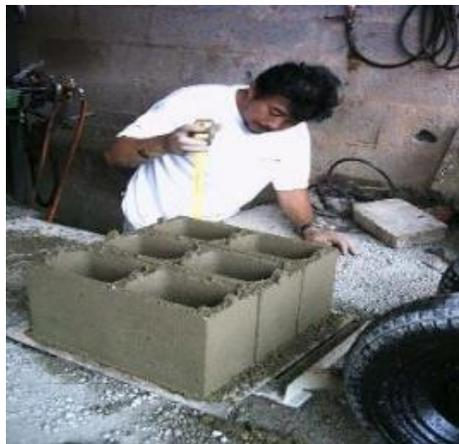
Após alguns ajustes, na terceira tentativa, os blocos foram moldados e desmoldados com sucesso, obtendo-se as dimensões previstas de 15,0 x 19,0 x 39,0 cm, correspondentes respectivamente à largura, altura e comprimento e tomando-se como referência a norma ABNT NBR-6136:1994 <sup>(7)</sup>.
