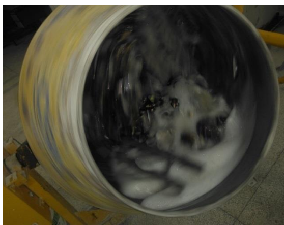
Figura 3 - Lavagem da casca de mexilhão na betoneira.
