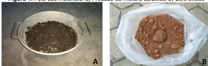
Figura 1: Foto dos materiais: a) Fresado de mistura asfáltica; b) Solo siltoso
