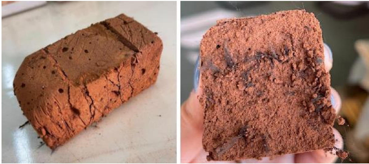
Figura 4: Corpo de prova com adição de fibras. (a esquerda); submetido ao ensaio de compressão em vista superior; (a direita): partido ao meio, visto em corte
