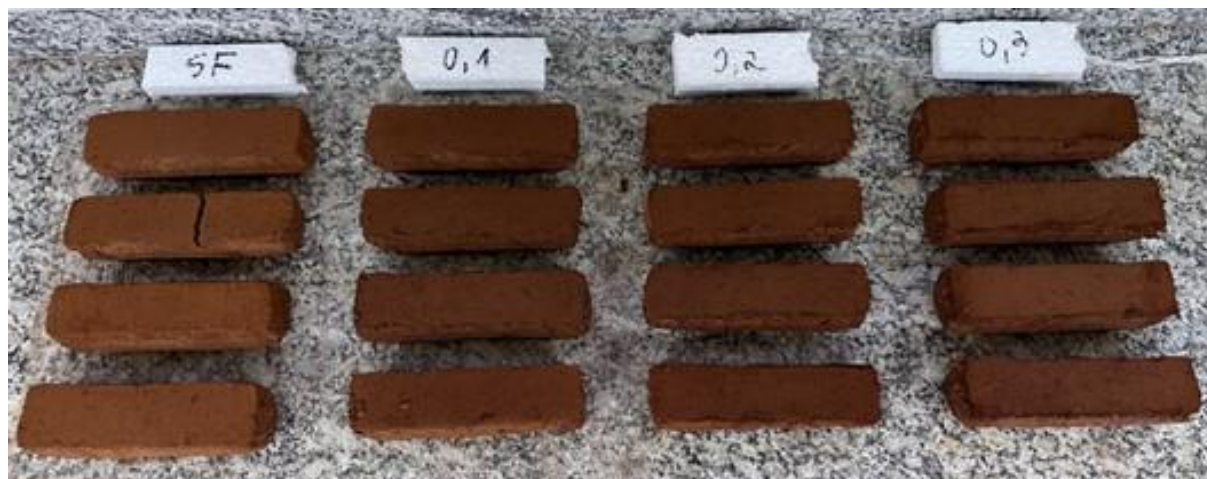
Figura 2: Corpos de prova desmoldados
