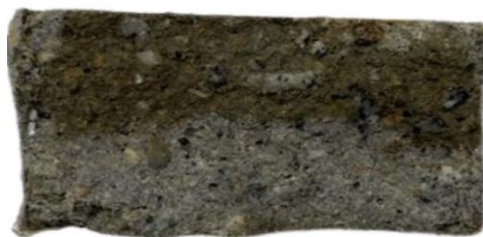
Figura 9: Reação do nitrato de prata com o cloreto penetrado
