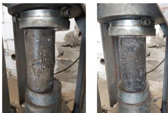
Figura 3: Rupturas mais comuns: a) Tipo C e b) Tipo E
