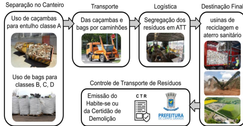
Figura 2: Fluxograma do passo a passo da gestão correta do RCC em Campo Grande-MS.
