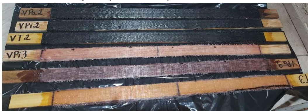
Figura 4: Vigas de madeira reforçadas com PRFC e PRFV
