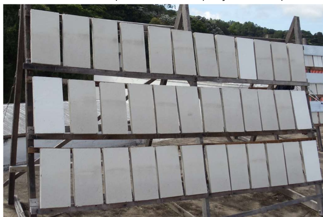
Figura 2: Amostras de tinta após 6 meses de exposição ao intemperismo natural
