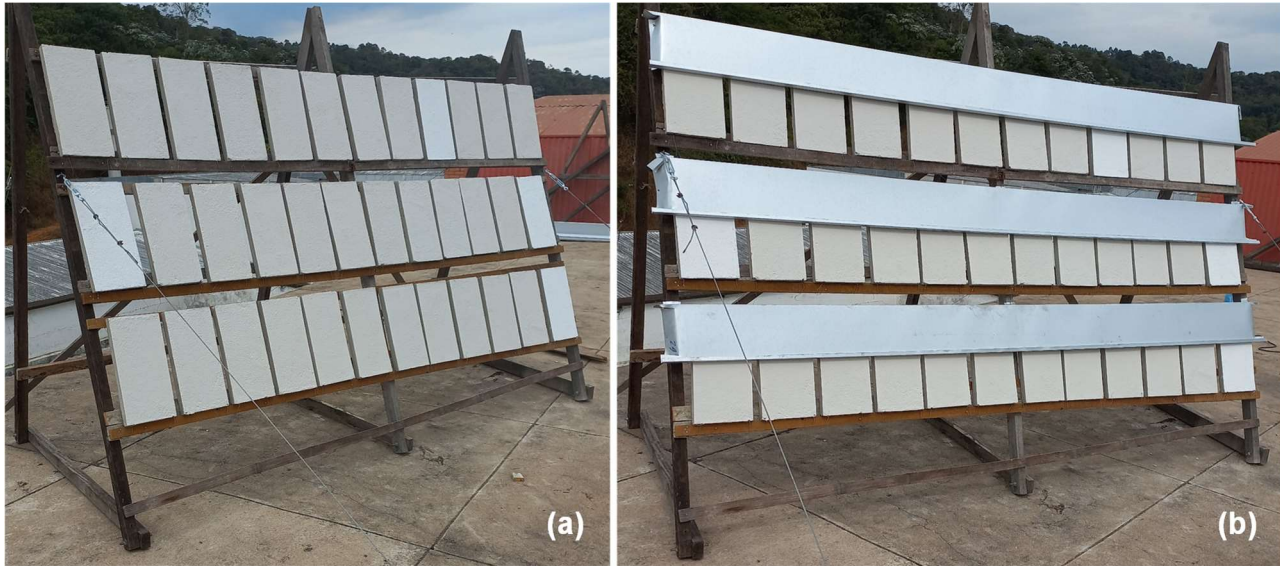
Figura 1: Amostras expostas o intemperismo: (a) antes da fixação da chapa metálica; (b) pós fixação da chapa metálica
