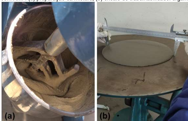
Figura 4: Argamassa com RMF: (a) preparação da mistura, (b) ensaio de trabalhabilidade: argamassa após os 30 golpes
