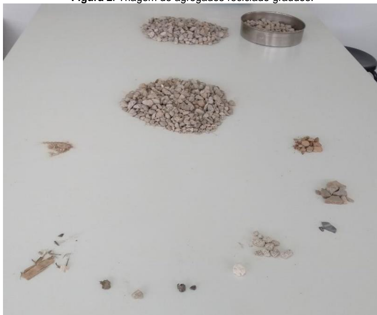
Figura 2: Triagem de agregados reciclado graúdos.
