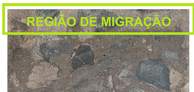
Figura 1: Exemplo de CP após aspersão de nitrato de prata e medição da região de PIC
