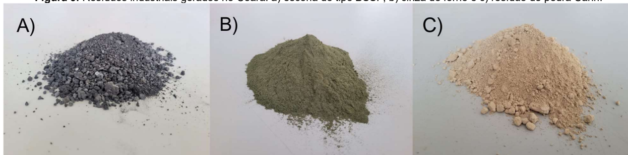
Figura 3: Resíduos industriais gerados no Ceará: a) escória do tipo BSSF, b) cinza de forno e c) resíduo de pedra Cariri.
