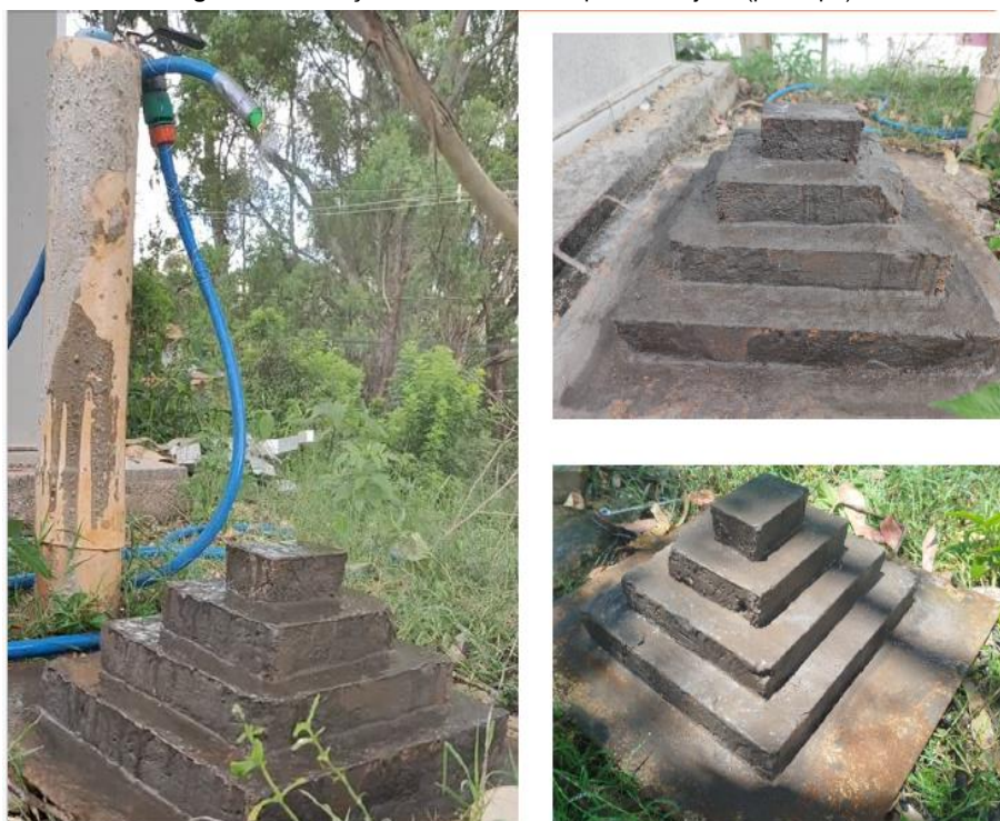
Figura 7: Simulação de chuva sobre a pilha de rejeito (protótipo)
