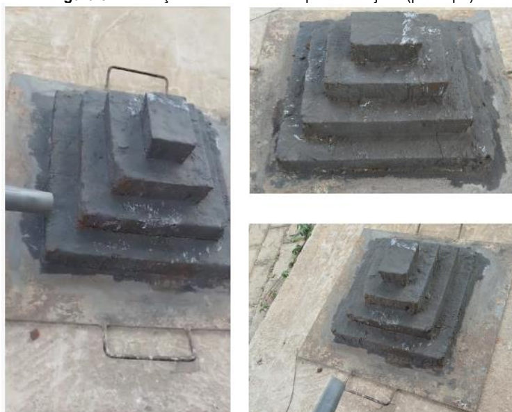
Figura 9: Simulação de vento sobre a pilha de rejeito (protótipo)
