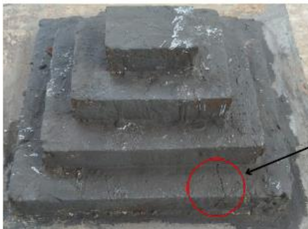
Figura 8: Fissuras observadas na pilha de rejeito (protótipo)
