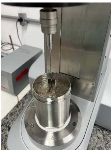
Figura 1: Visualização do ensaio rotacional com a argamassa 100EAF
