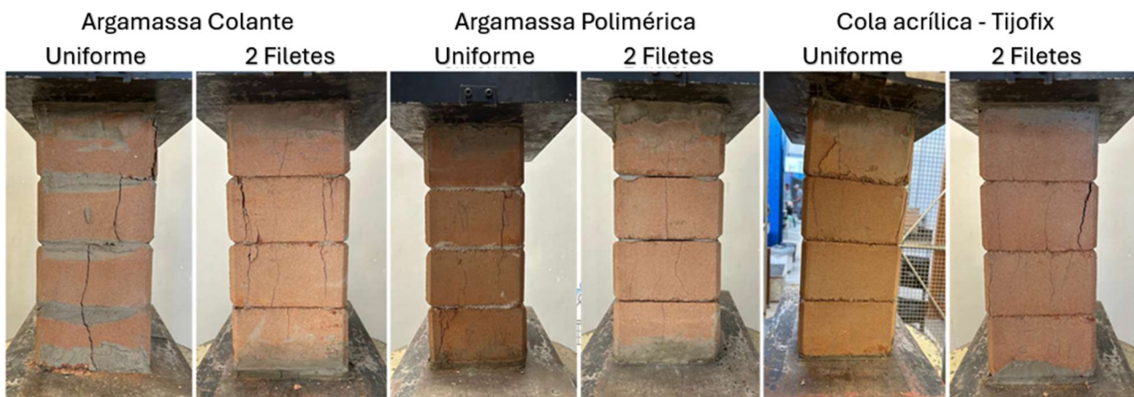
Figura 3: ruptura dos prismas com diferentes juntas de assentamento.
