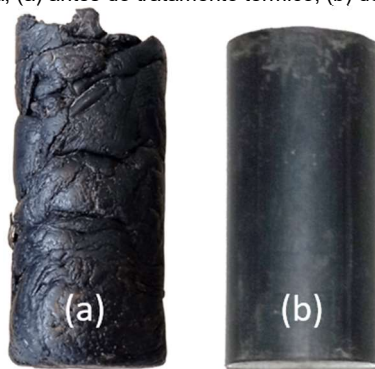
Figura 4: Corpos de prova; (a) antes do tratamento térmico; (b) depois do tratamento térmico
