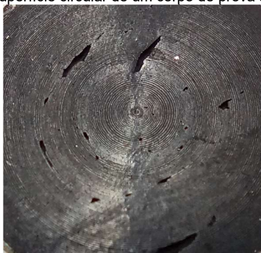
Figura 5: Detalhe da superfície circular de um corpo de prova após tratamento térmico
