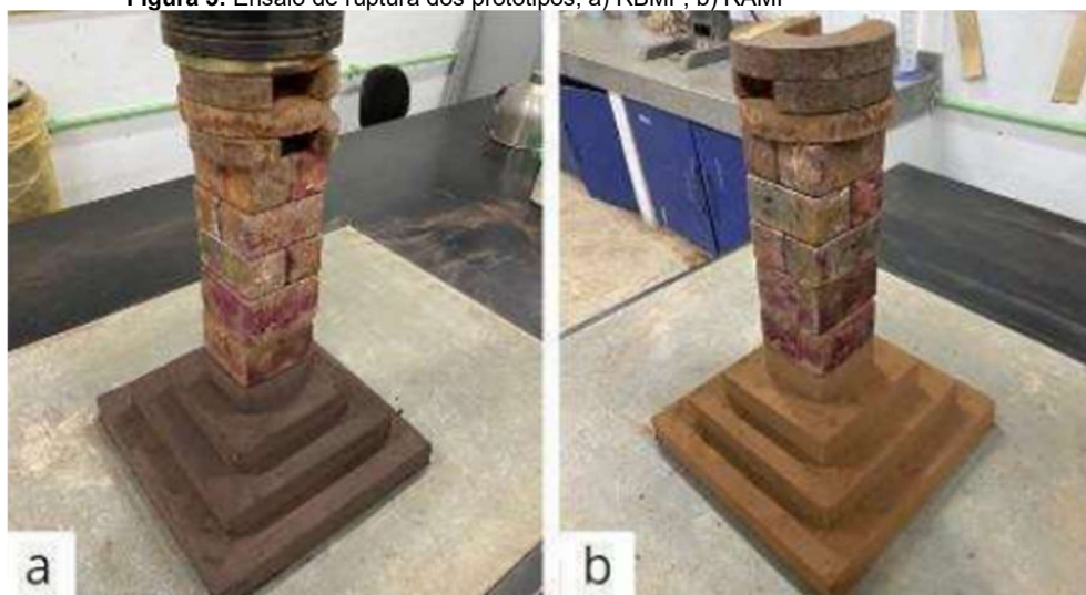
Figura 5: Ensaio de ruptura dos protótipos, a) RBMF, b) RAMF
