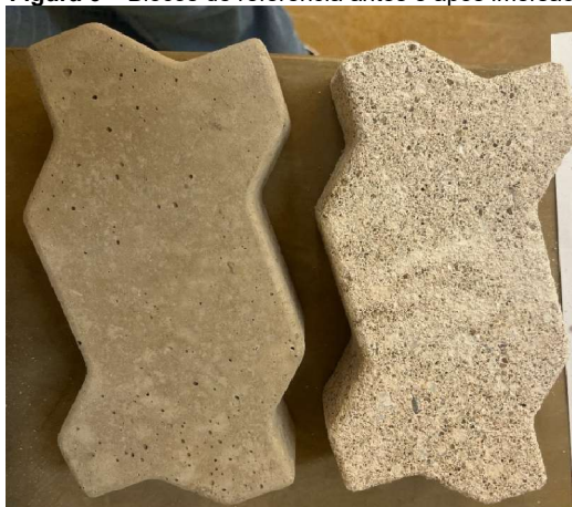
Figura 6 – Blocos de referência antes e após imersão
