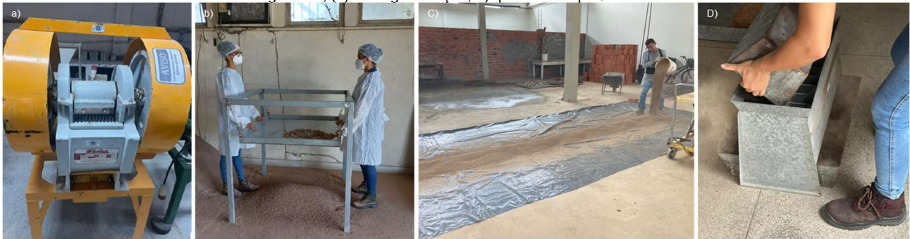
Figura 9: Processos de beneficiamento: (a) cominuição secundária - britador de mandíbulas; (b) separação do ARS em miúdos e grãos; (c) homogeneização; d) quarteador tipo Jones.
