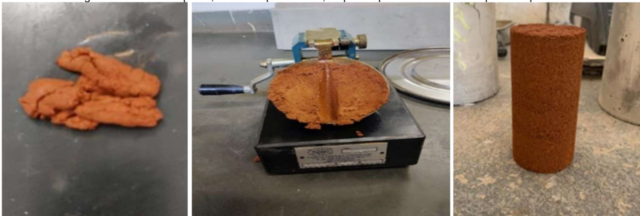
Figura 2 - Ensaio de liquidez; ensaio de plasticidade, corpos de prova confeccionados para compressão.
