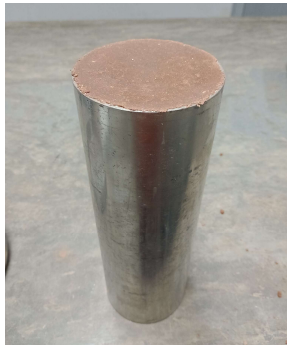
Figura 1: Coluna com M_{BSSF} compactada
