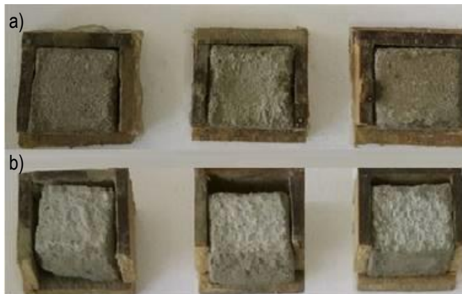
Figura 2 – a) Argamassa com pigmento. b) Argamassa de referência.
