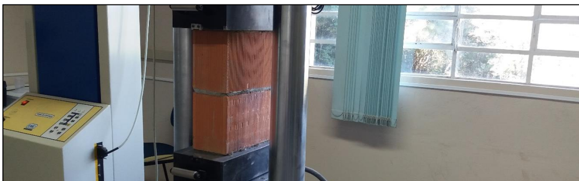
Figura 5 – Determinação da resistência à compressão do prisma.
