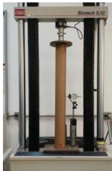
Figura 5 - Corpo-de-prova durante o ensaio de resistência (14) .
