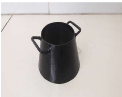
Figura 3 – Cone de fluxo.
