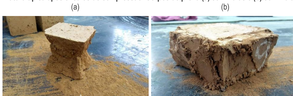
Figura 5 – Fratura típica após ensaios de compressão. Corpos de prova (a) sem fibras e (b) com fibras de R-PET.
