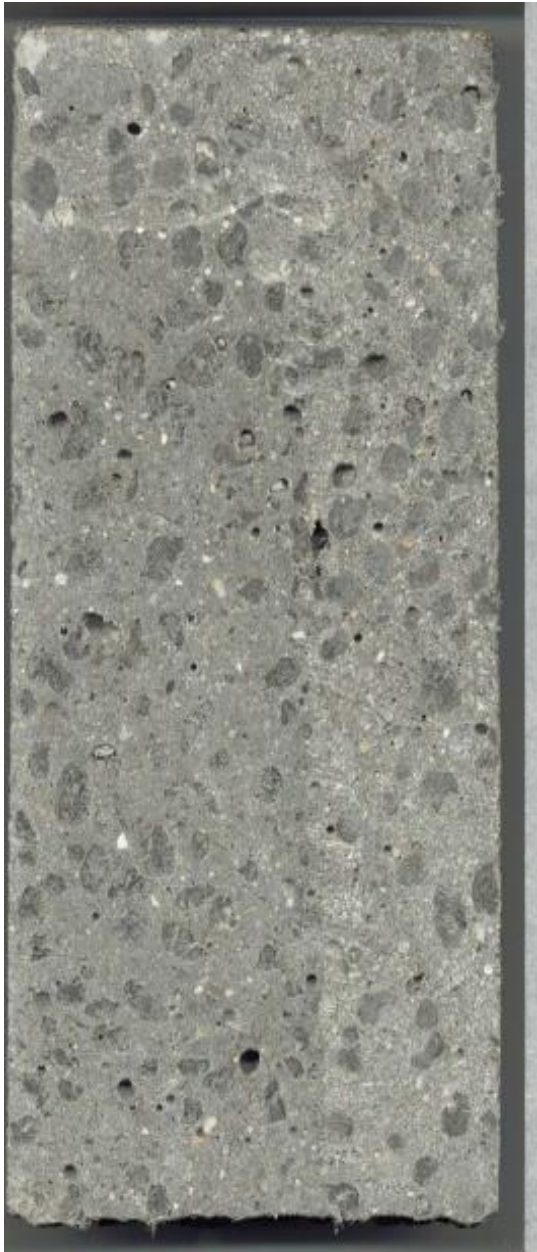
Figura 9: Cortes de seção diametral e transversal do tipo P6.
