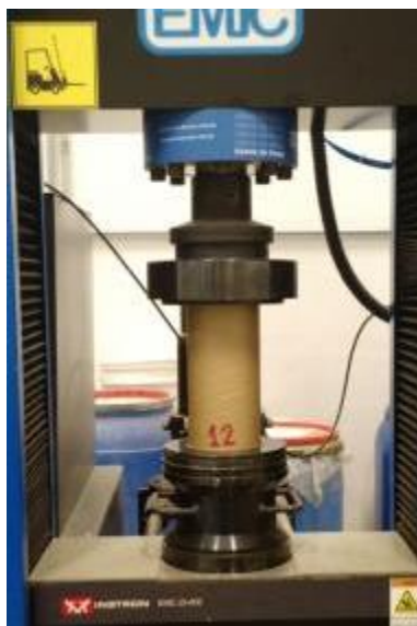
Figura 4 - Corpo-de-prova durante o ensaio de resistência à compressão (14) .
