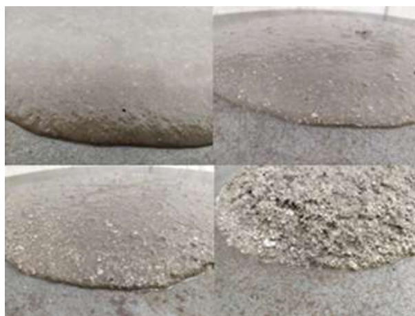
Figura 2 – Argamassas com substituição de 0%, 25%, 50% e 100%,
