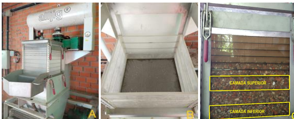
Figura 1 – (A) jigue hidráulico, (B) gavetas e (C) camadas analisadas no estudo.
