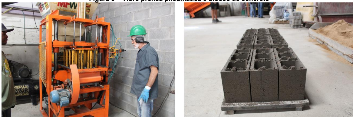
Figura 3 – Vibro prensa pneumática e blocos de concreto
