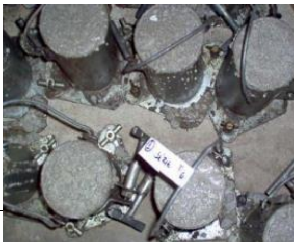
Figura 3: moldagem dos corpos-de-prova cilíndricos
