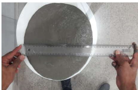
Figura 4 – Verificação da consistência.
