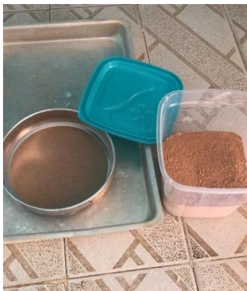
Figura 2 – Material passante na peneira de 100 mesh.
