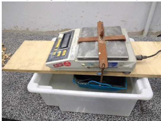
Figura 3 - Aparelhagem para o ensaio de absorção de água.
