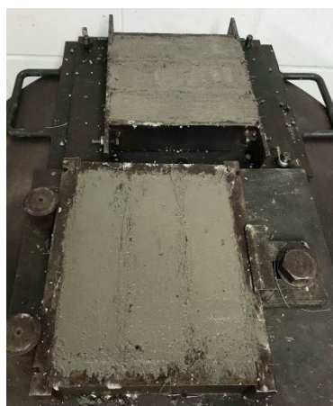
Figura 9 – Resultado final de corpos de prova de argamassa reforçados com fibras de coco moldados em formas metálicas prismáticas.
