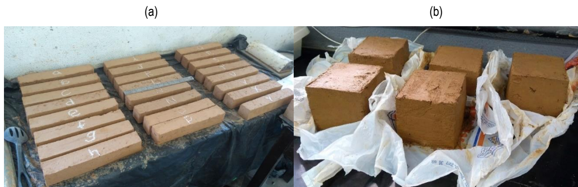
Figura 4 – Corpos de prova para os ensaios de a) flexão, retração e b) compressão em processo de secagem.
