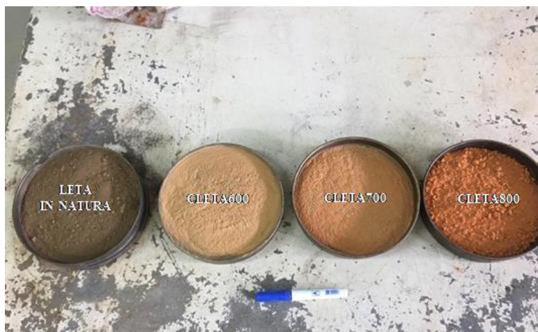
Figura 3 – Aspecto físico do LETA Bolonha in natura e ativado termicamente a 600 °C (CLETA600), 700 °C (CLETA700) e 800 °C (CLETA800).
