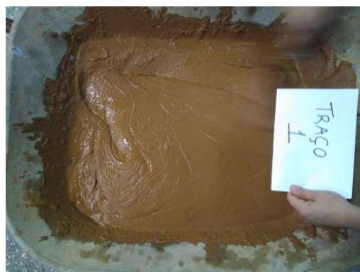
Figura 3 - Consistência da mistura com 100% solo
