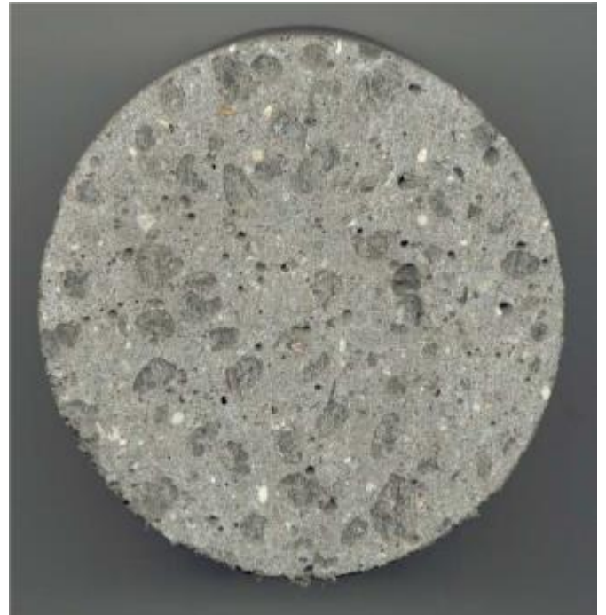
Figura 9: Cortes de seção diametral e transversal do tipo P6.
