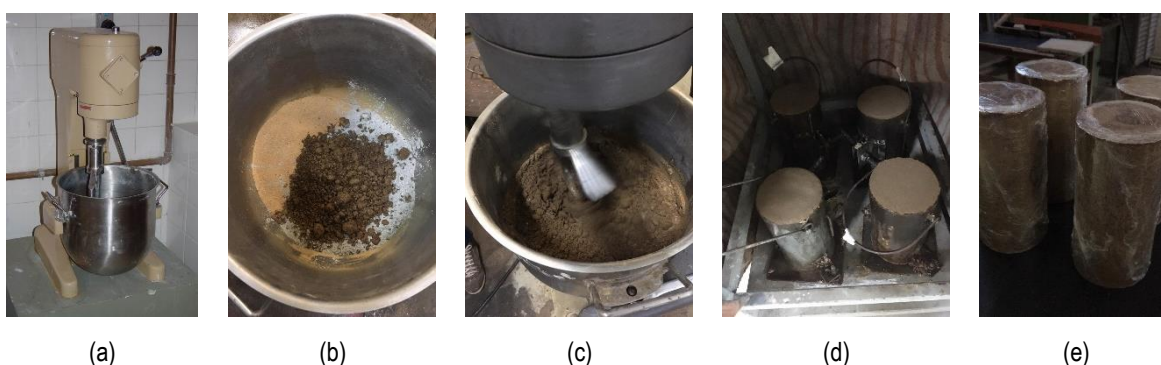
Figura 3: Preparo e moldagem das misturas: (a) Argamassadeira; (b) Colocação dos materiais granulares na cuba; (c) Realização da mistura após a inserção da água; (d) Corpos de prova moldados no armário de cura; (e) Corpos de prova selados com filme plástico.
