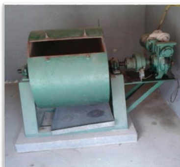
Figura 1- Aparelho Abrasão Los Angeles.
