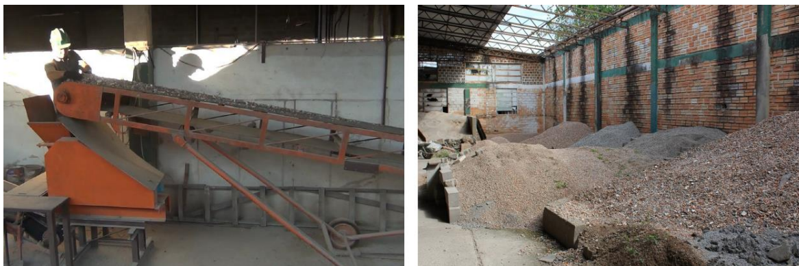
Figura 2 – Esteira com britador e armazenamento dos agregados
