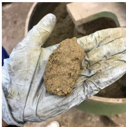
Figura 2 – Método do ponto de pelota
