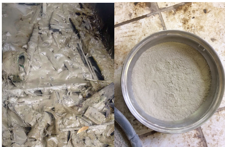
Figura 1,2 - Obtenções do Resíduo do Corte do Mármore e Granito (RCMG). 1) Em forma de lama na máquina de corte; 2) Seco e Peneirado para o uso no concreto; Fonte: Autores.
