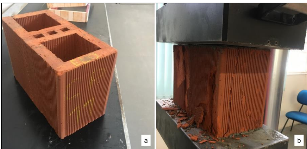
Figura 1 – a) Bloco cerâmico estrutural utilizado; b) Determinação da resistência à compressão do bloco.
