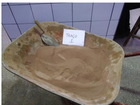
Figura 2 – Mistura dos materiais secos
