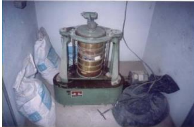
Figura 5: Peneiras para os ensaios de granulometria
