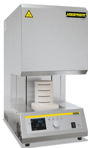
Figura 3 - Forno laboratorial utilizado, com temperatura máxima do equipamento de 1650^\circ\text{C} .
