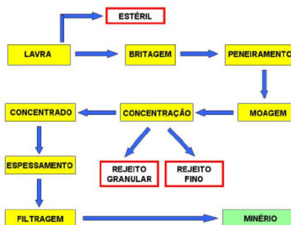
Figura 1 - Esquema típico do processo de mineração de ferro.
