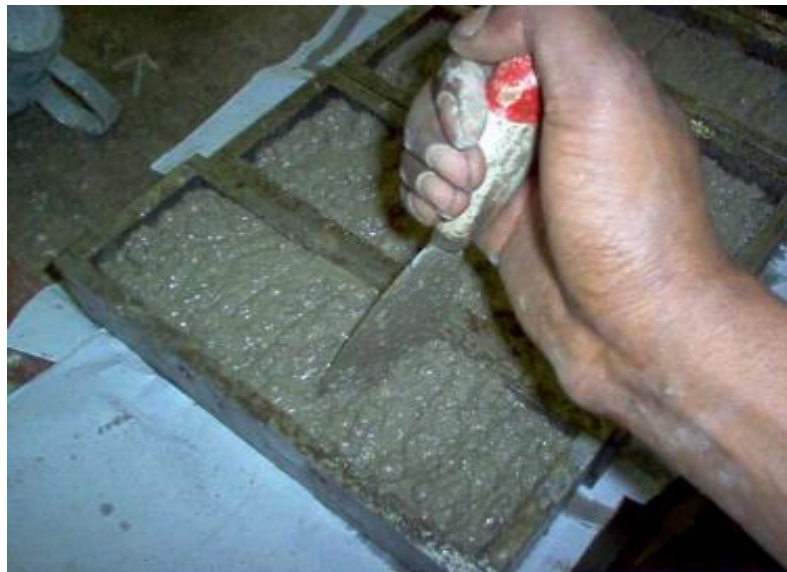
Figura 2: Moldagem dos corpos-de-prova cúbicos
