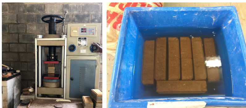
Figura 2 - Ensaio de resistência à compressão (esq.) e de absorção (dir.) dos BTCs
