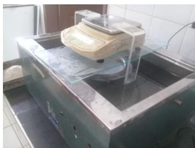
Figura 1. Ensaio de absorção do RCD.
