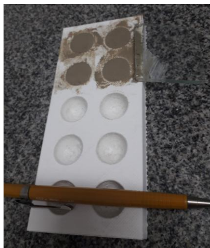
Figura 2 - Pellets em molde de poliácido láctico.
