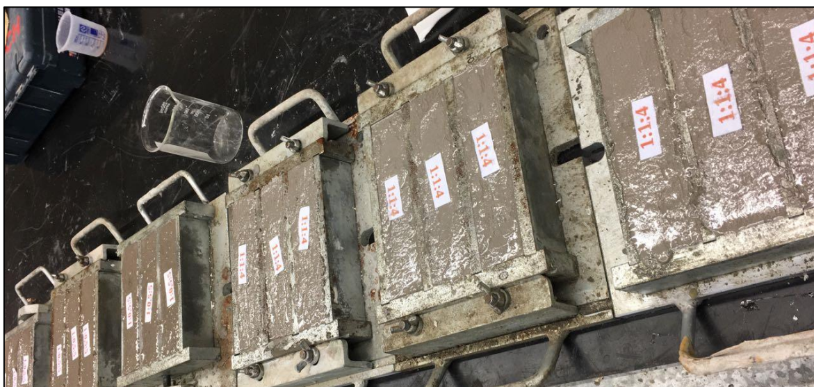
Figura 2 – Moldagem dos corpos de prova de argamassa.
