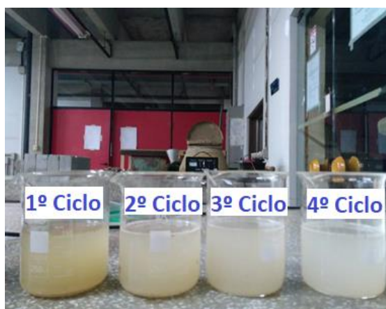
Figura 4 - Amostras de água retiradas a cada ciclos de lavagem das cascas de mexilhão.
