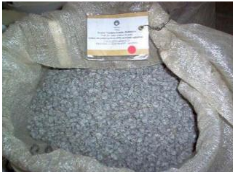
Figura 1: grãos reciclados aglutinados de polipropileno – GRAPP
