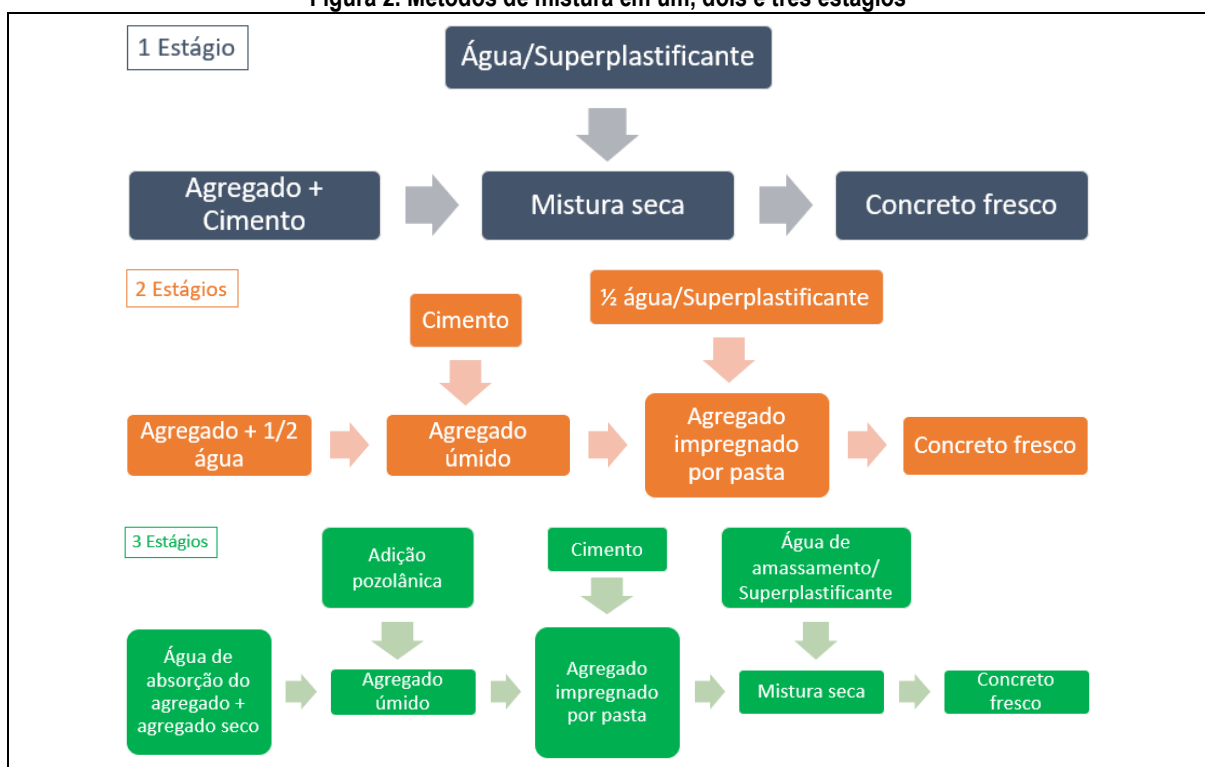
Figura 2. Métodos de mistura em um, dois e três estágios
