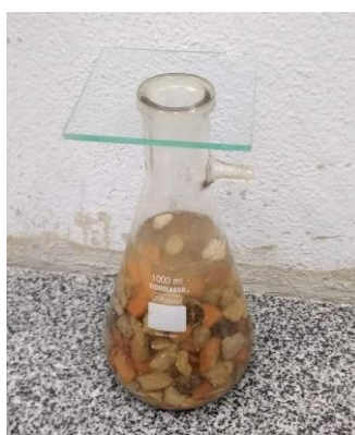
Figura 2 - Picnômetro com água e amostra tampado com a placa de vidro.
