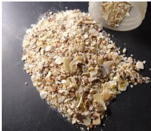
Figura 5 – Aspecto do agregado miúdo produzido a partir da casca de mexilhão.
