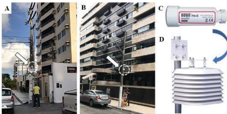
Figura 4 - Instalação do equipamento HOBO modelo U23-001; (A) em postes de iluminação pública na Av. Prof. Sandoval Arroxelas (B) na Av. Dep. José Lages e (C) dentro de shield contra radiação solar e chuva e (D) HOBO.
