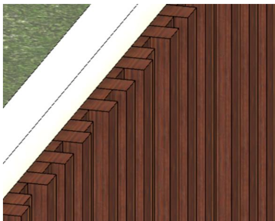
Figura 13 - Controlador de tempo de reverberação, tipo painel (AUTORES, 2023).
