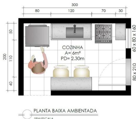
Figura 2 – Planta baixa ambientada de cozinha, com mobiliário mínimo e dimensões adotadas.
