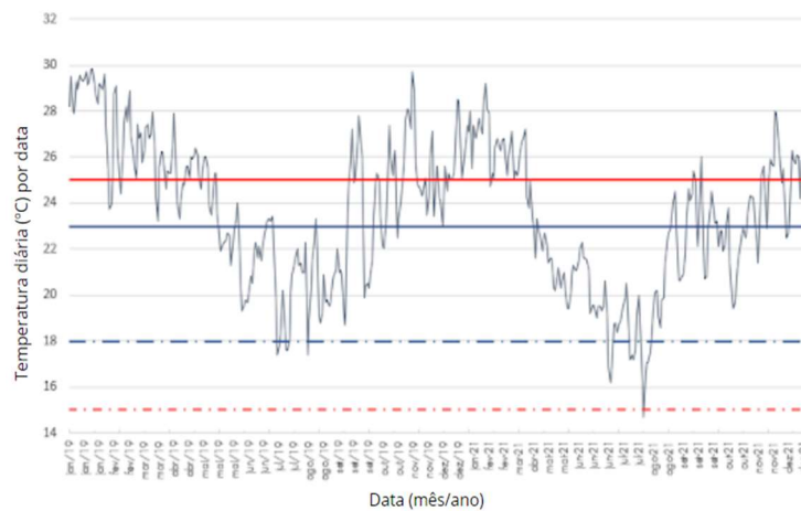
Figura 7 - Gráfico de Temperatura Média por data da sala do Anexo do AHM.
