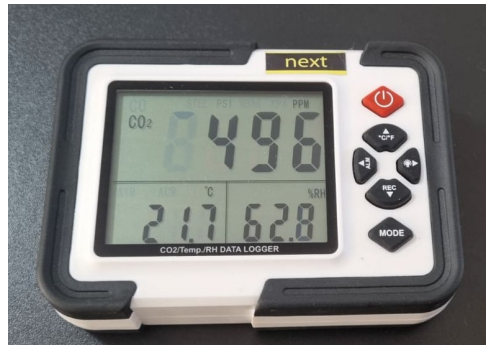
Figura 5 – Medidor de CO 2 (Autores)
