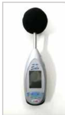
Figura 7: sonômetro Solo da 01 dB.
