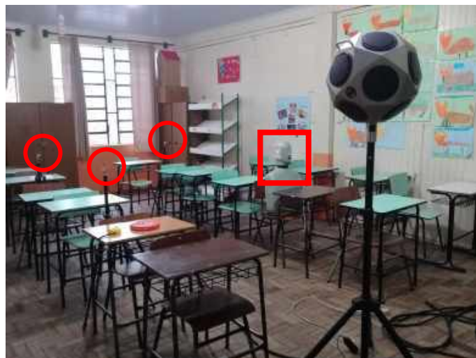
Figura 2 – Configuração com o posicionamento da fonte sonora, cabeça artificial – indicada pelo retângulo vermelho – e microfones distribuídos na sala de aula – indicados pelos círculos vermelhos. (Os autores, 2018).
