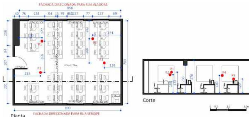
Figura 3 - Planta e Corte da sala 1102
