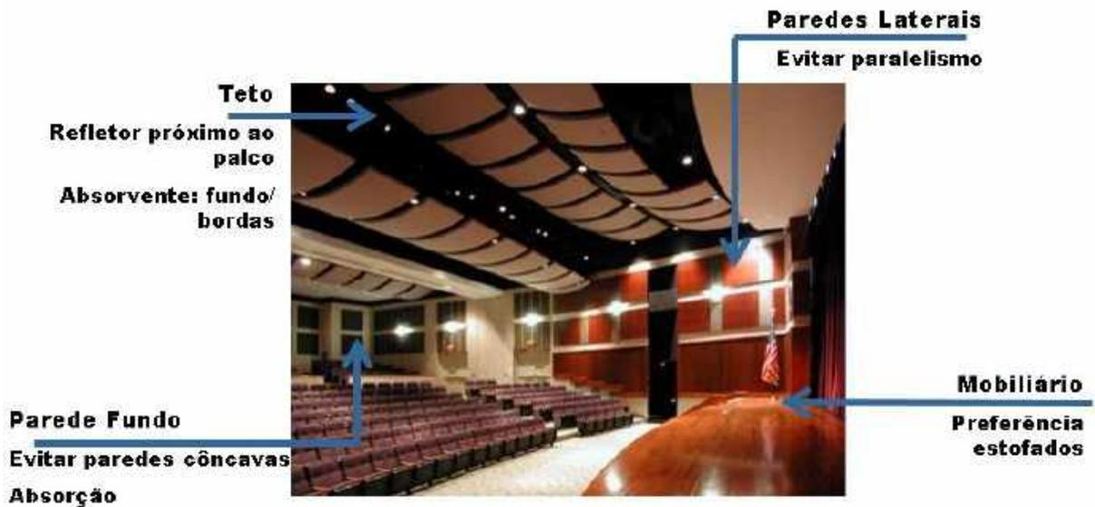
Figura 13 – Esquema demonstrando o uso de materiais absorventes e reflexivos em um auditório.
