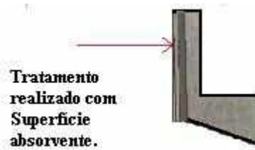
Figura 12 –Uso de superfície absorvente para ajustar o tempo de reverberação do ambiente (Fonte: adap. SOLANO,2017).
