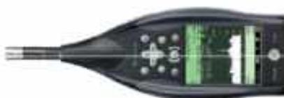
Figura 6 – Medidor de nível sonoro. (BRÜEL&KJÆR, 2015).
