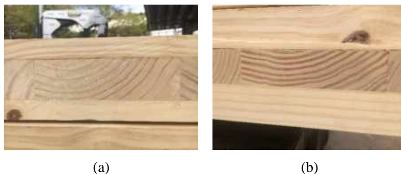
Figura 4 – Painéis ensaiados em laboratório: (a) Painel de CLT de 80mm e (b) Painel de CLT de 120 mm
